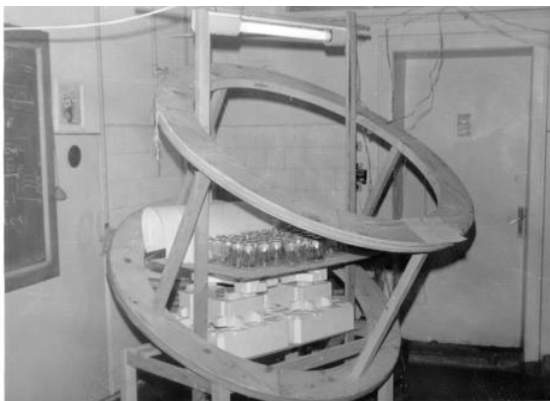
Fig.3.1. Sistem de compensare a componentei statice a câmpului geomagnetic – Bobina Helmholtz
