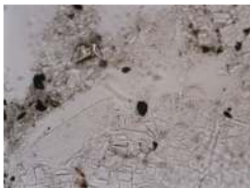
Fig.8.b. Cristale tabulare cu clivaj foarte bun de polihalit, secțiunea P7, Praid (1N, 35X)
