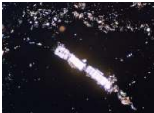
Fig.7.a. . Cristale tabulare de anhidrit, secțiunea S8, Sovata (N+, 35X)
