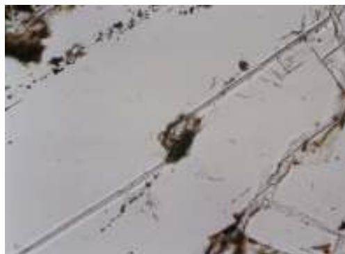
Fig.6.b. Anhidrit cu clivaj în unghi drept, secțiunea S3 Sovata (1N, 45X)
