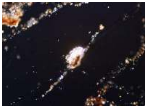
Fig.6.a. Anhidrit cu clivaj în unghi drept, secțiunea S3 Sovata (N+, 45X)
