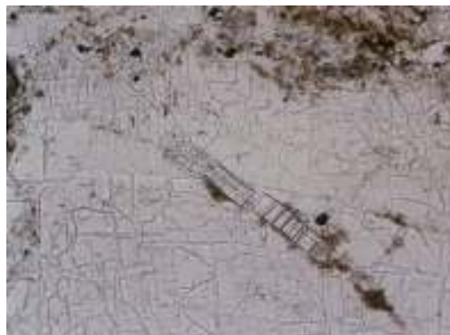
Fig.7.b. Cristale tabulare de anhidrit, secțiunea S8, Sovata (1N, 35X)
