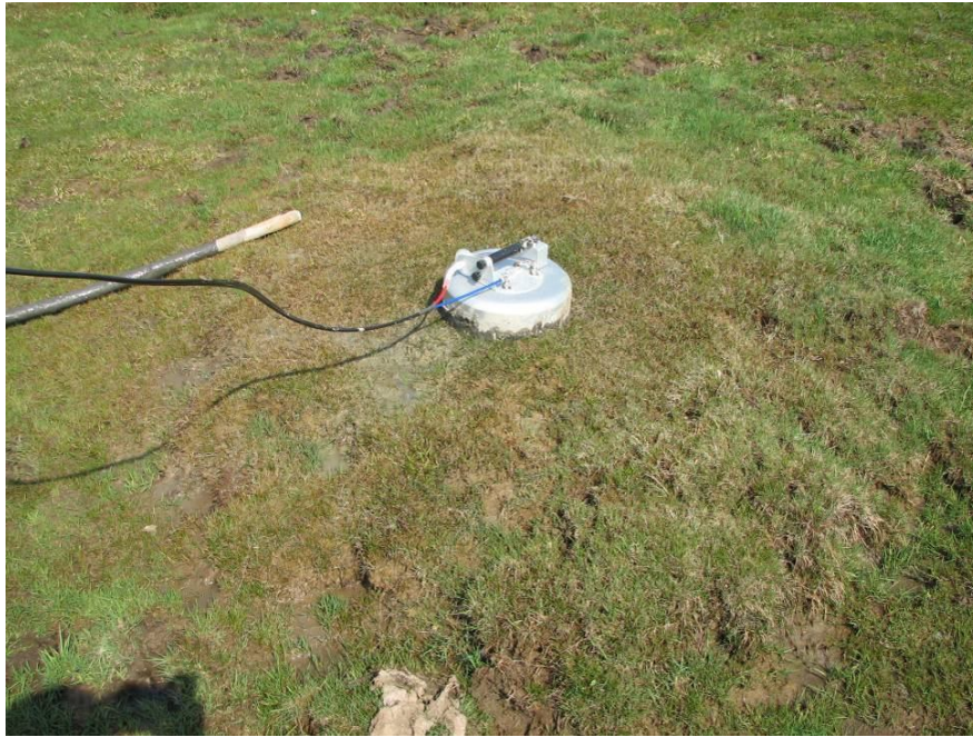
Fig. 6.4.3 Măsurători în perimetrul zonelor înmlăștinite cu boltiri pronunțate datorită gazelor acumulate
