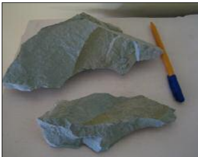
Fig. 4.3. Eșantioane de tuf vulcanic zeolitic din Cariera de la Valea Morii (prelevare și foto: Irina Smical)
