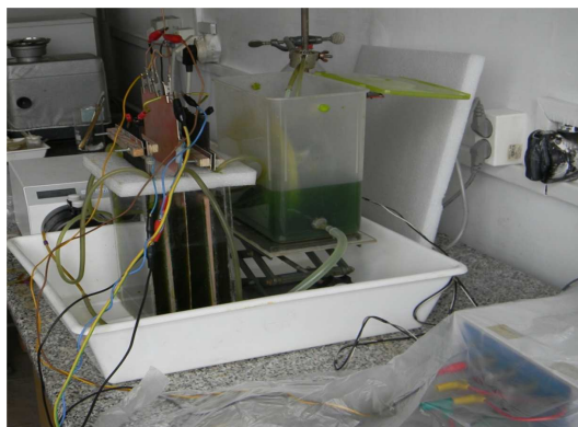
Figura 6.3. Instalația de RCu din deșeu de PCI prin dizolvare chimică / electrodepunere catodică.
