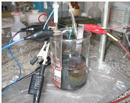
Figura 6.1. RE de RCu din deșeu de PCI prin dizolvare anodică / electrodepunere catodică.
