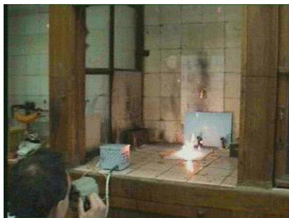
Figura.nr.5 Modul de executare a testului de determinare a temperaturii de combustie Se pornește pirometrul și se începe măsurarea temperaturii[153,154].
