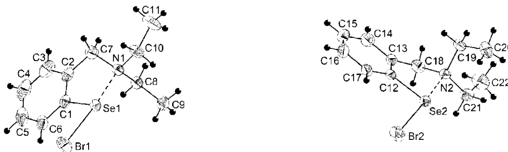
Figura 26. Diagrama ORTEP la probabilitate de 30% și schema de numerotare a atomilor pentru izomerii S_{N1} - 16a (stanga) și R_{N2} - 16b (dreapta)
