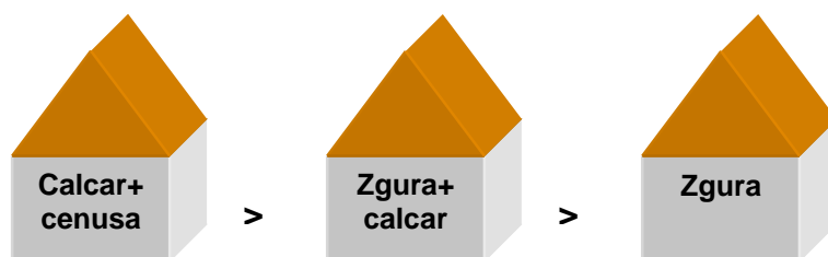
Fig. 7.3.2 - Concentratia de radon din interior in functie de tipurile de adaosuri utilizate la fabricarea cimenturilor
