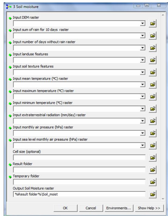
**Fig. 6.2.** Interfața grafică a modulului GIS dezvoltat pentru calculul umezelii solului folosind metoda bilanțului
