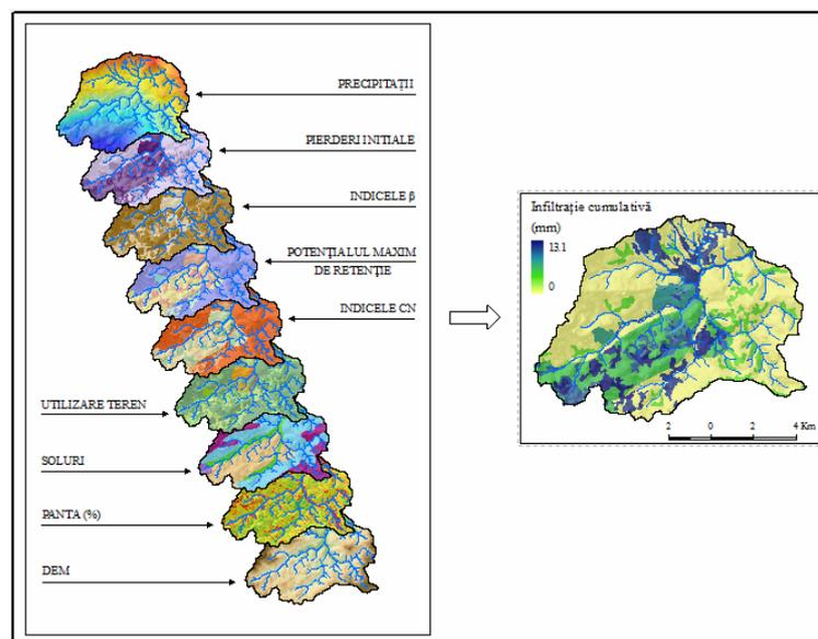
**Fig. 6.3.** Layere necesare pentru spațializarea infiltrației cumulative
