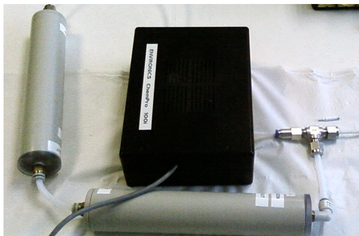
Figura 6. Spectrometrul de mobilitate ionică cu câmp electric transversal ChemPro100i IMS (Environics Oy).
