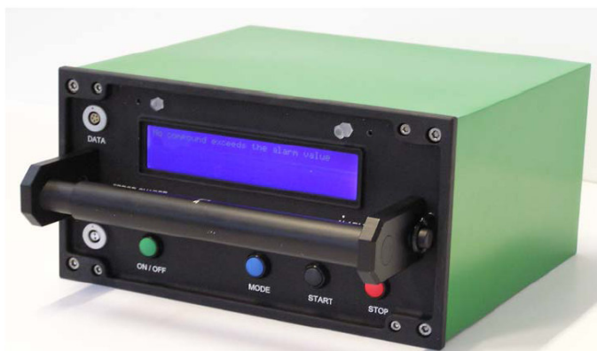
Figura 4. Spectrometrul de mobilitate ionică IMS-MINI (I.U.T. GmbH Berlin)
