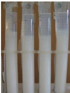
**Figure 4.13:** a) Sédimentation du  $\text{TiO}_2$  en présence du dispersant D1 (5% ; 10% ; 20% ; 50%).
