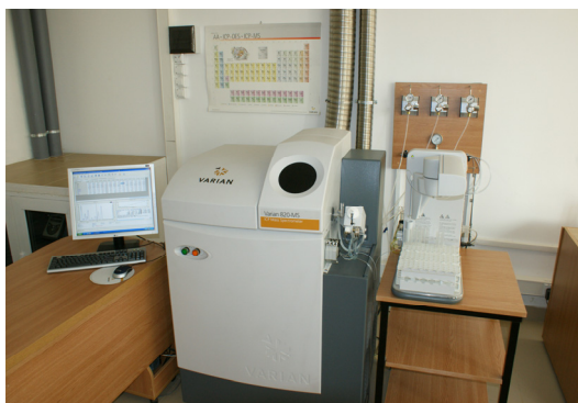
Figura 1.1. Spectrometrul de masă cu plasmă cuplată inductiv ICP-MS Varian 820 cu autosampler SPS3 Roboprep
