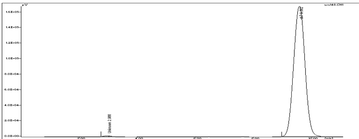
Figura 2.9. Cromatograma QCI-ASA, condiții: coloană Nucleosil C18(250x4,6mm), eluent CH 3 CH:tampon fosfat 50:50, pH=3, debit 0,5 ml-min, \lambda=316 nm
